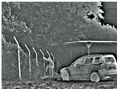
**Filter 3** - Bildfilter zur Beobachtung von Objekten bei hoher Umgebungstemperatur und geringem Temperaturunterschied dazwischen.
